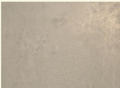
Kalkglätte, pigmentiert, geglättet, verdichtet mit Glätteseife
